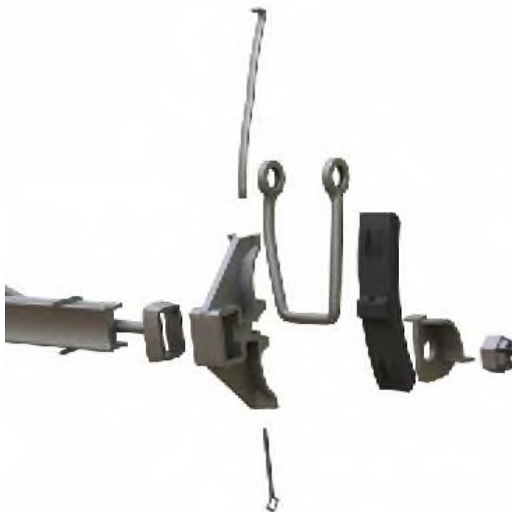
Рис.39. Крепление колодки к триангелю
